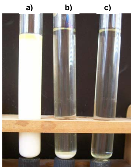
Figura 5.4. Aspecto físico de los productos antes de su incorporación al fulón del proceso: a) producto comercial (Bio F-36, Pellital S.A.), b) Muestra A ( gemini 4b ) y c) Muestra B ( gemini 4e ).
