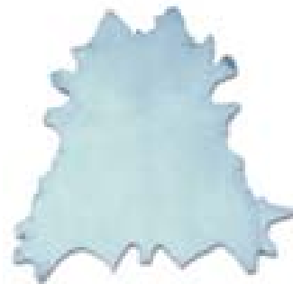
Figura 1.5. Aspecto característico del cuero luego del curtido al cromo ( wet blue ).
