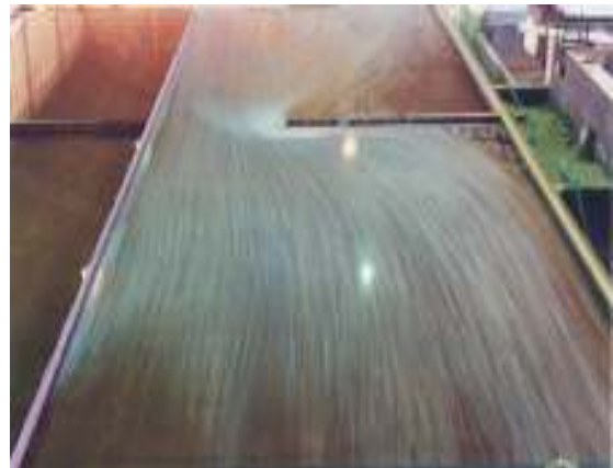
Figura 0.1 Fotografía del patrón de flujo establecido en el gran cuenco experimental de la FICH.
