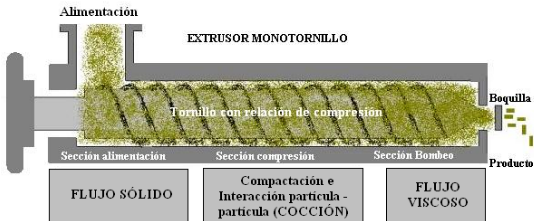
Figura I.12 – Transformaciones del material durante la extrusión (extrusor monotornillo).
