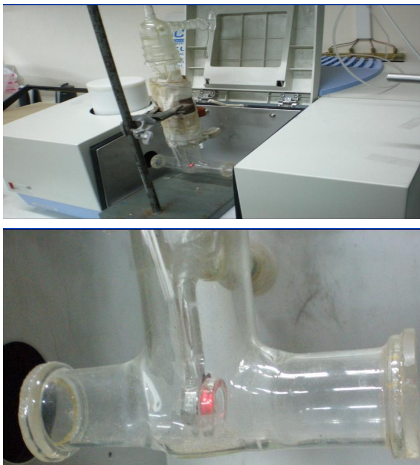
Figura II.3. Celda de Infrarrojo empleada para realizar los experimentos de adsorción y desorción de CO.
