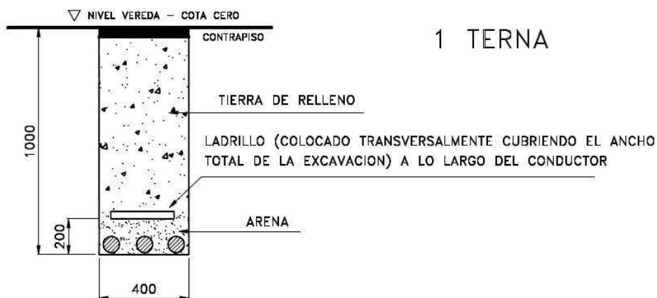
Figura 4.20. Detalle constructivo tendido de LSMT
