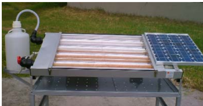
Figura 1.4 Reactor solar autónomo (Plataforma de Almería, España)
