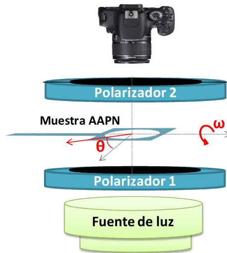
Figura 3.19: Esquema experimental utilizado para el análisis de la birrefringencia en AAPN. Los polarizadores se mantienen cruzados y pueden rotar un ángulo \theta respecto de la muestra. El plano de la membrana se puede inclinar un ángulo \omega respecto del de los polarizadores.
