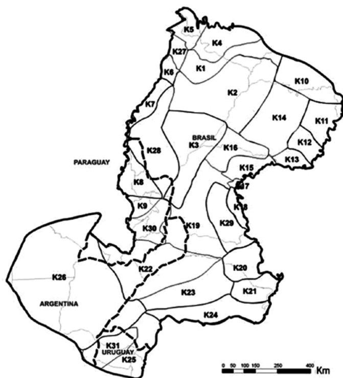
Figura 6. Zonificación de conductividad hidráulica y valores de K calibrados: CASO 1A (estacionario) y CASO 1B (transitorio). Figure 6. Hydraulic conductivity zone and calibrated K values: CASE 1A (steady-state) and CASE 1B (transient).
