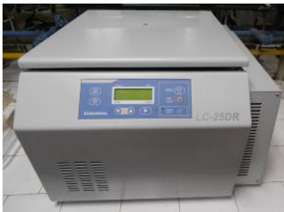
Figura 2.3. Centrifuga utilizada en las determinaciones de WRV, solubilidad en NaOH 9% (-5°C) y Reactividad de Fock.
