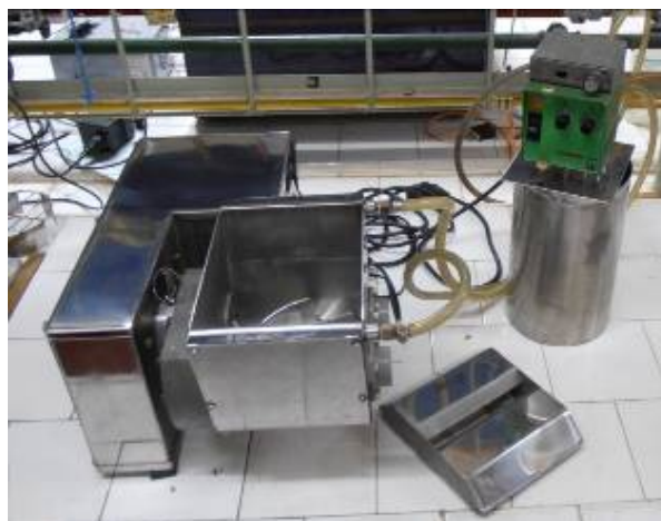
Figura 2.8. Vista general del reactor batch de acero inoxidable.
