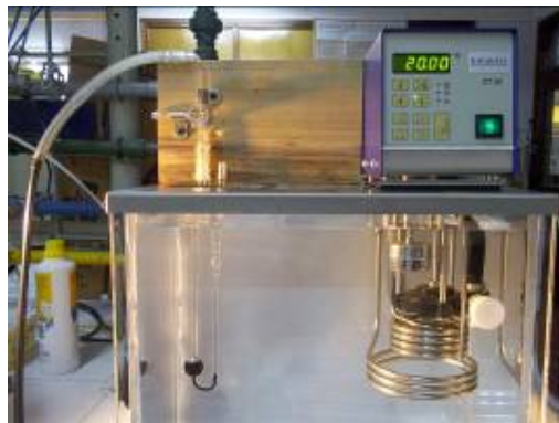
Figura 2.1. Baño termostático transparente y viscosímetro capilar utilizados.
