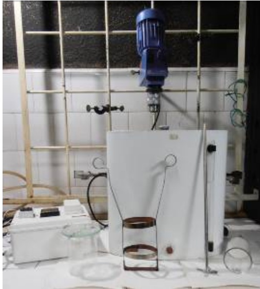
Figura 2.18. Baño de aceite de silicona con controlador de temperatura para TSGT y material utilizado.
