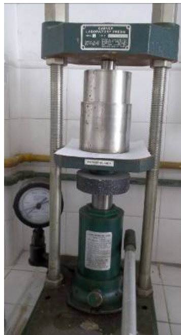
Figura 2.11. Vaso para prensado y prensa hidráulica utilizados.
