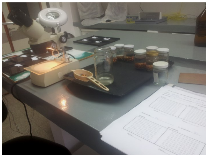
Figura III-1: Equipamiento para la determinación de viabilidad mediante la prueba topográfica de TZ en laboratorio de semillas del INTA Oliveros.
