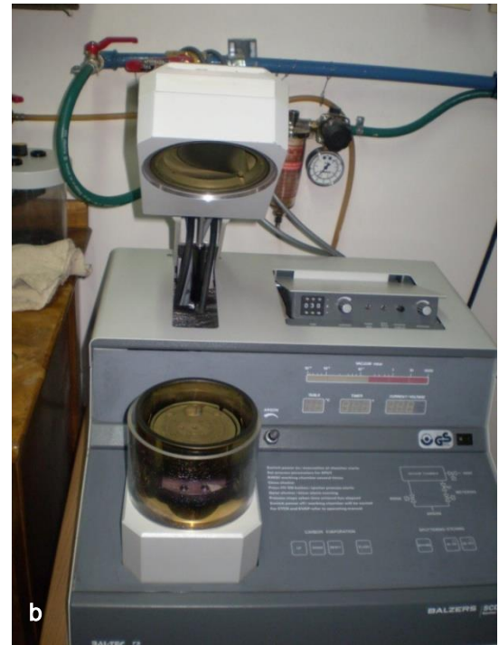
Figura N° 24: Preparación de muestras para SEM. a- Porta muestras de aluminio con adhesivos de carbón donde se coloca la muestra. b- Equipo metalizador Balzers SCD 050.
