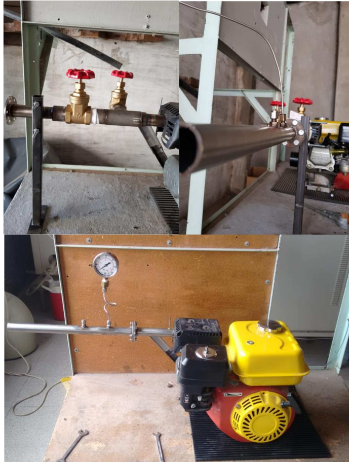
Figura 1: Sistema de escape diseñado para emplazar un catalizador monolítico.
