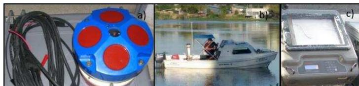
Figura 2.- a) ADCP Río Grande Teledyne RD Instrument 1200 kHz, b) Embarcación hidrográfica y c) Ecosonda Raytheon simple haz
