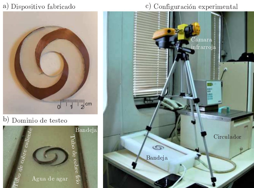
Figura 3.33: Experimento de inversión de flujo térmico: a) dispositivo artesanal; b) dominio de análisis; c) configuración del experimento.
