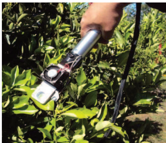
Figura 5. Medición del intercambio gaseoso del metabolismo fotosintético en las hojas correspondientes al naranjo 'Navelate', utilizando un sistema portable de analizador infrarrojo de gases (CIRAS-1).
