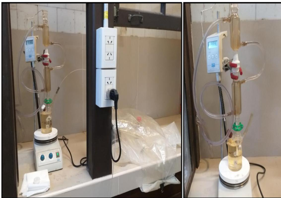
**Figura 2.4.** Dispositivo de laboratorio para la realización de la etapa de modificación superficial.
