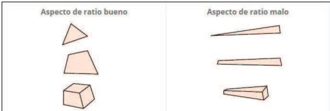
Figura 4.19: Geometría de elementos recomendables (izquierda) y no recomendables (derecha) en una malla de elementos finitos. Fuente: Manual de SisBaHiA.
