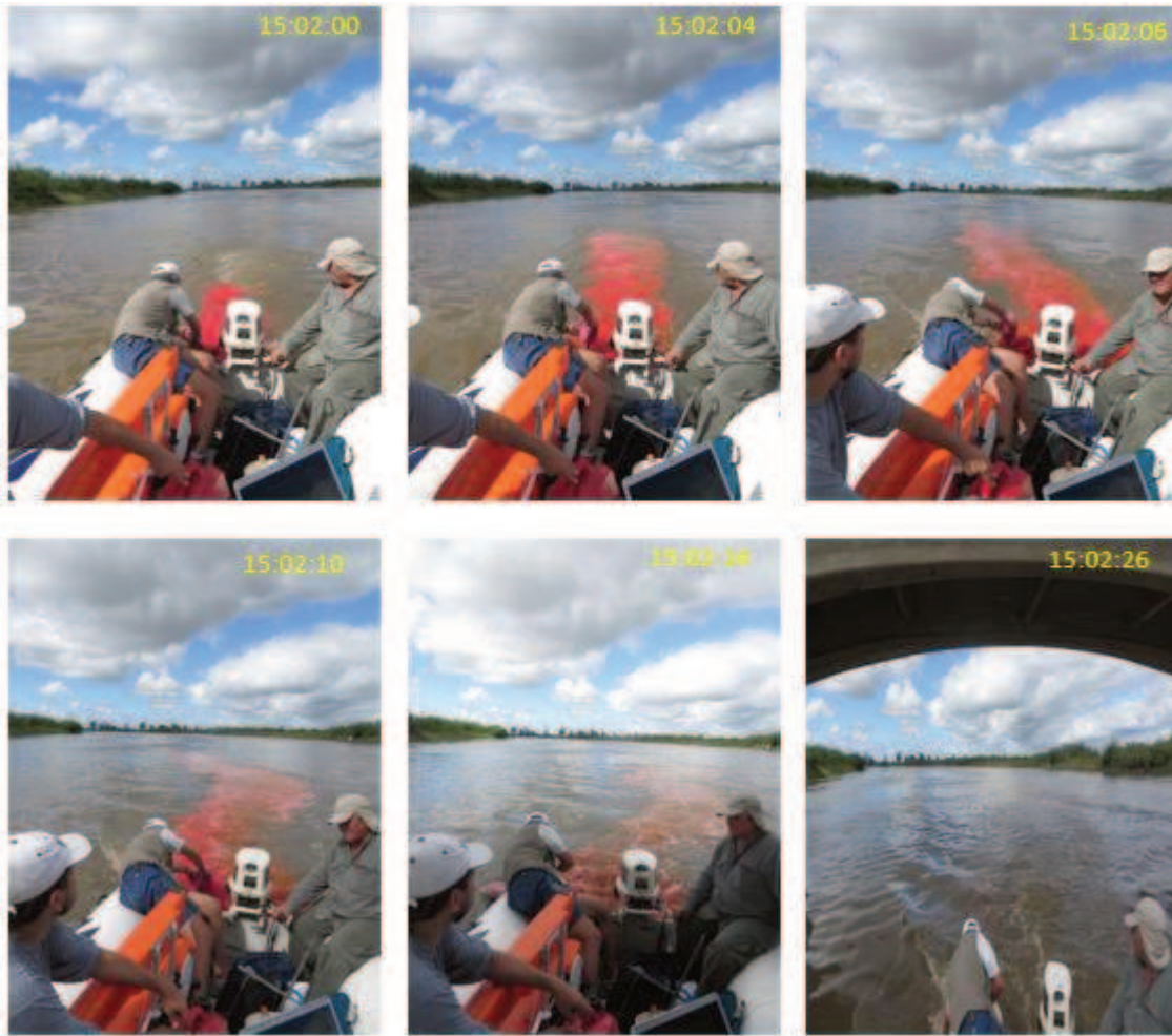
Figura 6.9: Inyección del trazador. Secuencia fotográfica.
