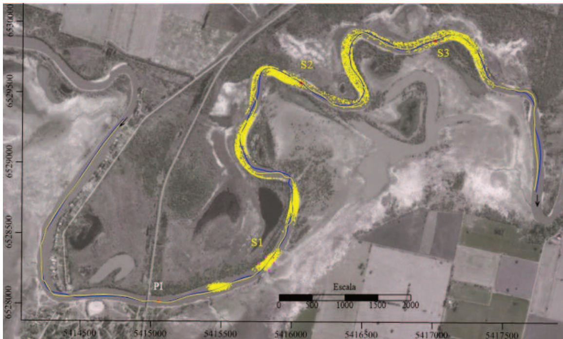
Figura 7.14: Evolución de la nube de partículas simulada para los tiempos 900 s, 1500 s, 2100 s, 3000 s, 3900 s, 5100 s y 6300 s. Línea de talweg (traza amarilla) y línea de máxima velocidad (traza azul) y ubicación de secciones de medición de trazador.
