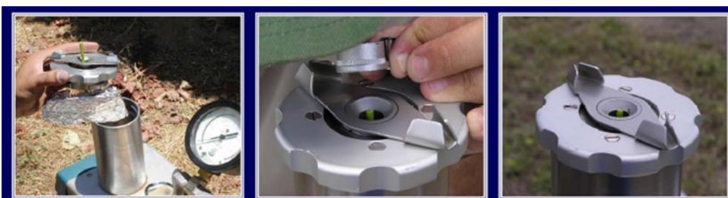
Figura II.4: Colocación de la hoja en la cámara de presión, (a) observación con lupa, y (b) determinación del potencial agua de la hoja a la presión en que se produce la aparición de una gota de agua en el corte del pecíolo de la hoja (c).
