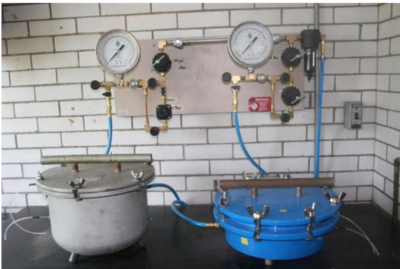
Figura II.3: Ollas de baja y alta presión para la determinación de las curvas de retención hídrica del suelo.
