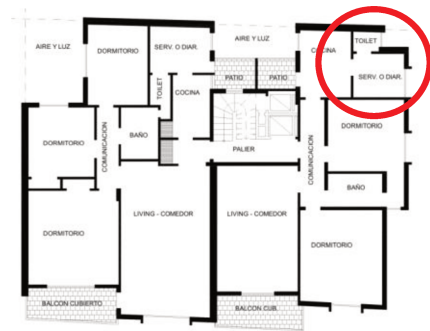
PLANTA TIPO – Localización de daños.
