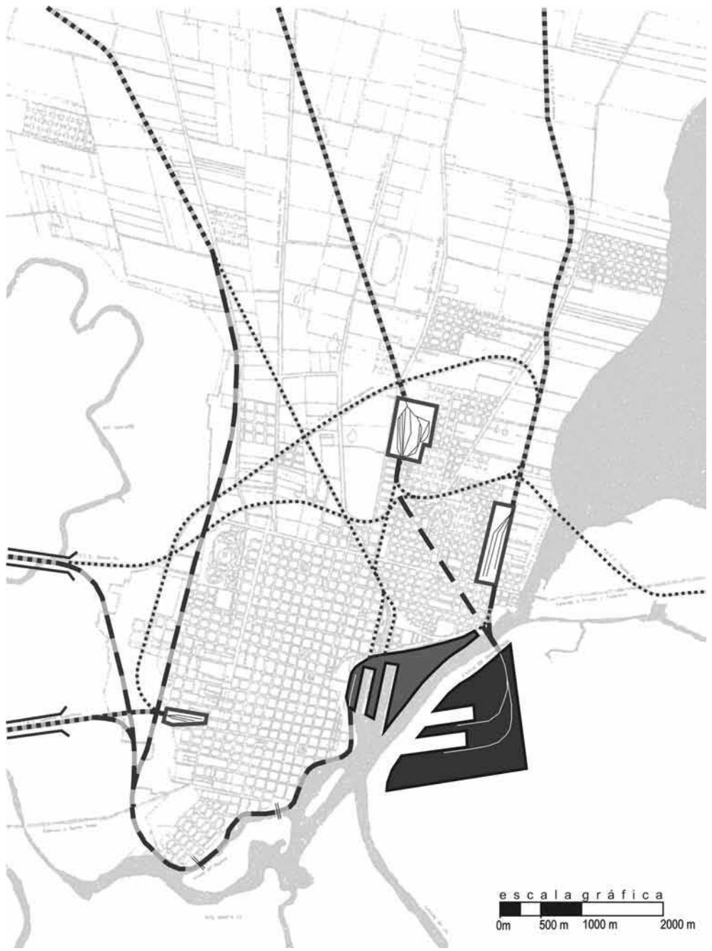
5. Propuesta de reestructuración ferroviaria del plan: vista superpuesta de instalaciones eliminadas, confirmadas e incorporadas por el plan. Reconstrucción de acuerdo con la documentación del Plan. Ver referencias figura 1.
