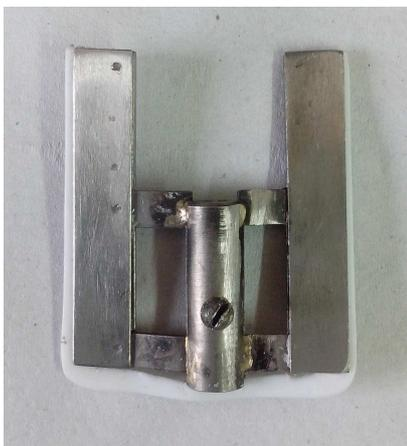
**Figura 6.5.** Agitador en forma de ancla.
