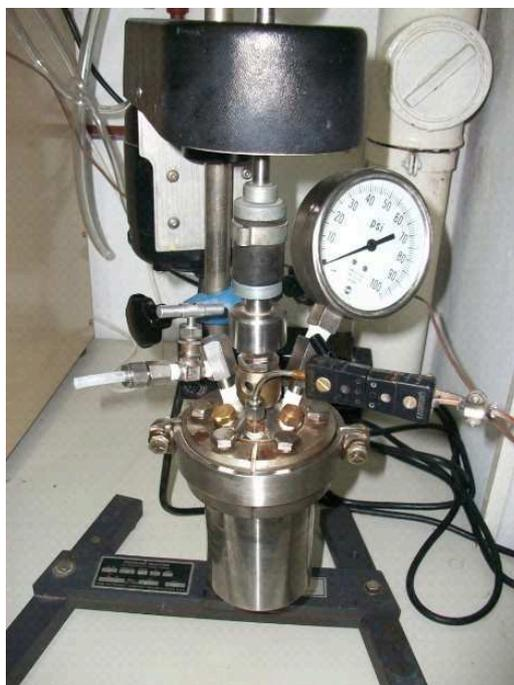
**Figura 2.4.** Fotografía del mini-reactor utilizado para el post-tratamiento térmico.
