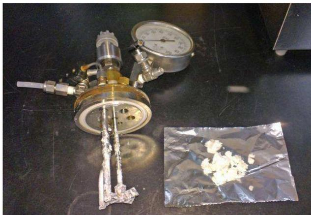
**Figura 2.11.** Fotografía del coágulo obtenido durante una post-polimerización térmica.
