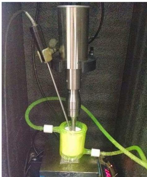
**Figura 2.1.** Equipamiento de ultrasonido utilizado para preparar las miniemulsiones.
