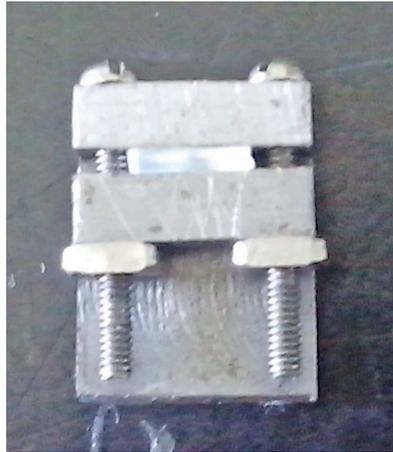
**Figura 2.15.** Fotografía de una mordaza empleada para sujetar la muestra y realizar el corte para observación de la superficie en AFM.
