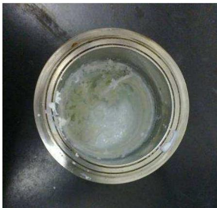
**Figura 6.4.** Fotografía de interior del mini-reactor Parr al final de la post-polimerización a 130 °C (IT2) del látex PB<sub>5</sub>K<sub>0.75</sub>, donde se muestra el coágulo formado en las superficies internas del reactor.
