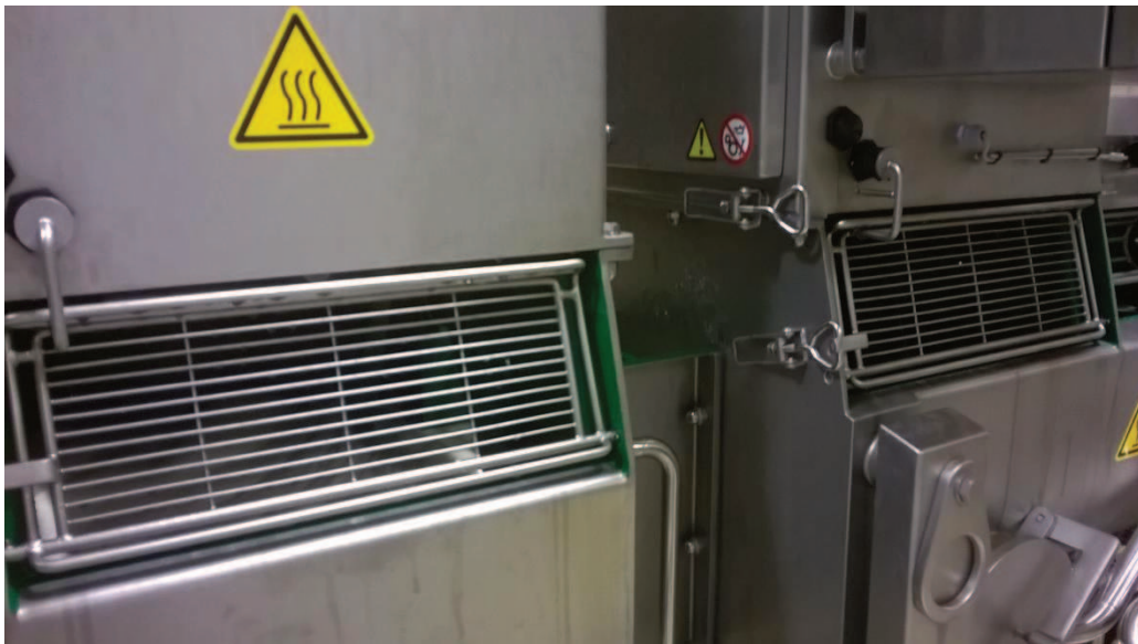
Figura 2.10 Hiladora para Mozzarella de muy alta humedad, detalle del doble juego de brazos de inmersión.
