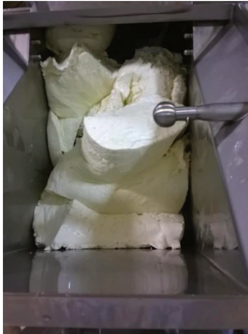
Figura 2.7 Ingreso de los bloques de cuajada en la tolva de la hiladora. En primer plano se puede ver el sistema de aspersión para limpieza CIP.
