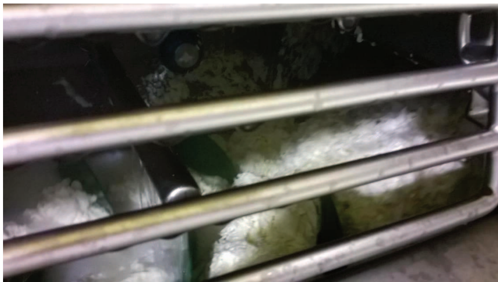
Figura 2.8 Comienzo del hilado en sinfin con agregado del agua caliente.
