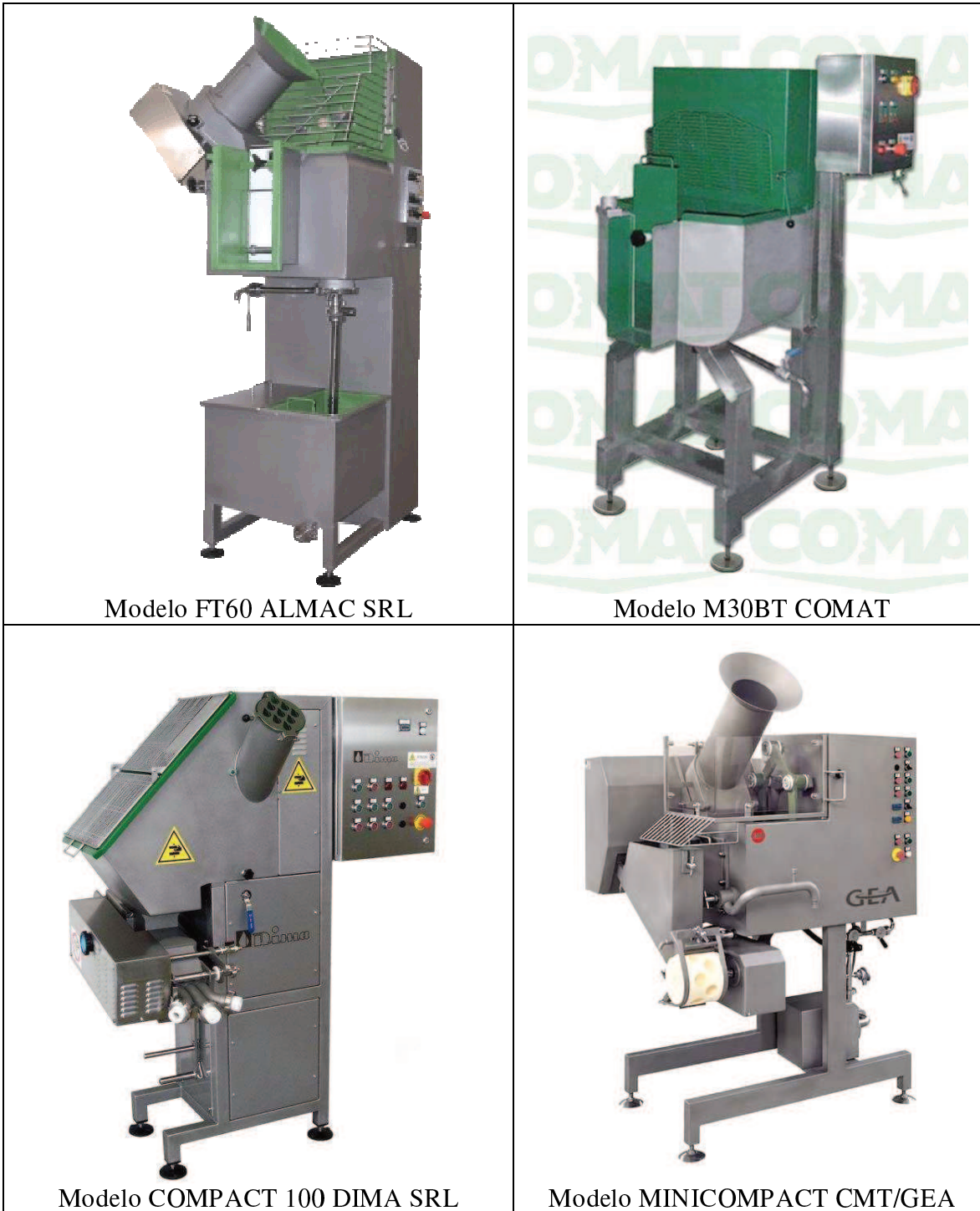
Figura 4.17 Modelos italianos de hiladoras compactas.
