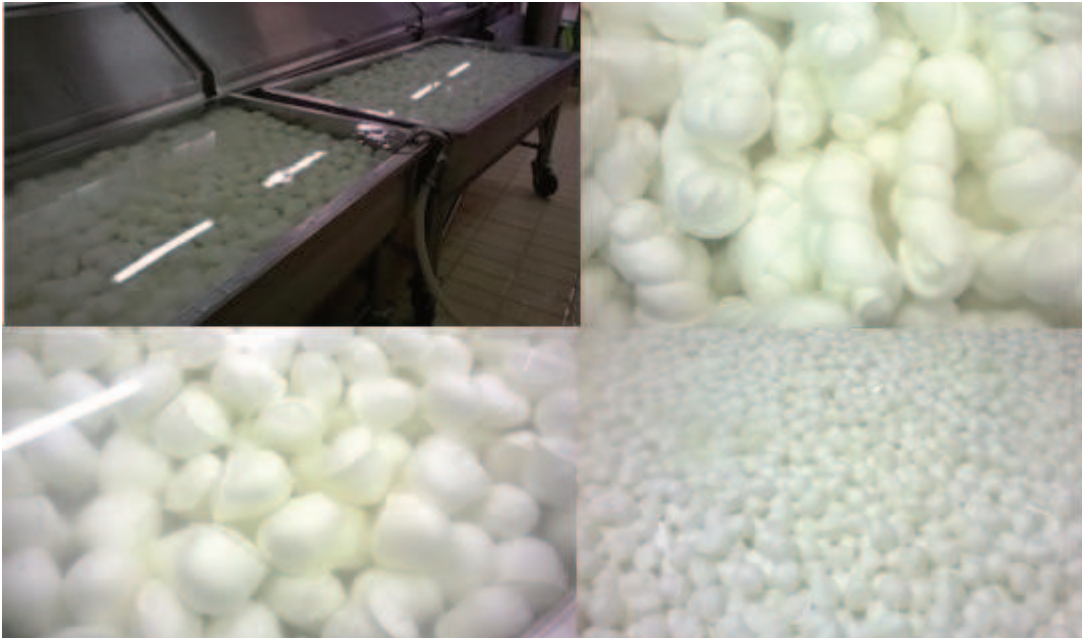
Figura 2.15 Bateas de enfriamiento de las formas (en ángulo superior izquierda), distintas formas de Mozzarella de alta humedad en enfriamiento luego del moldeo.
