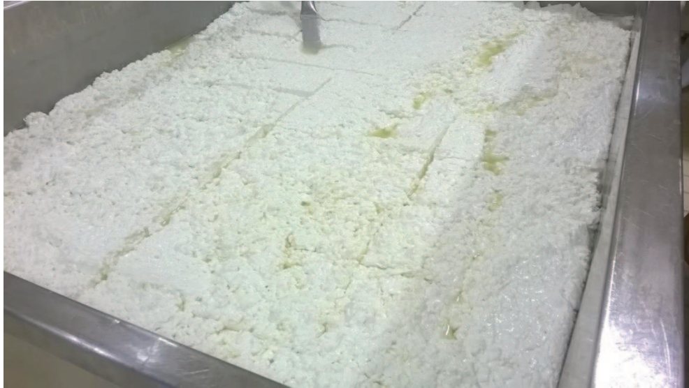
Figura 2.6 Cuajada en batea de acidificación sin suero, cortada en bloques para posterior ingreso en hiladora. Se observa parte de la lanza de acero inoxidable utilizada para el corte de los bloques.
