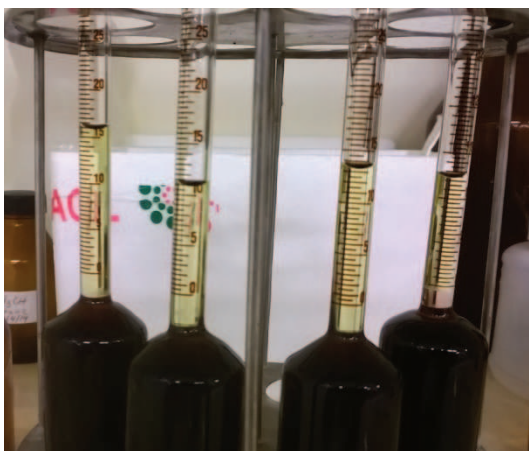
Figura 5.5 Análisis de grasa método de Gerber van Gulik, butirómetros.
