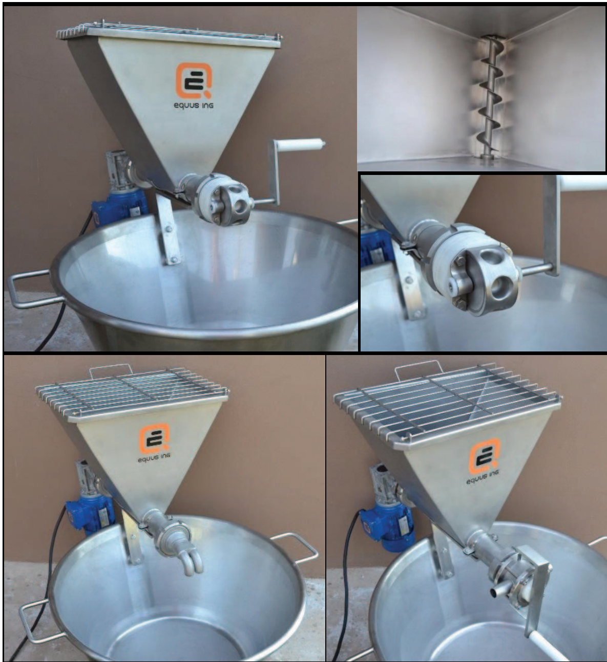
Figura 4.22 Formadora montada en la batea de acero inoxidable. Detalle del sinfín interno y de los tres cabezales disponibles.
