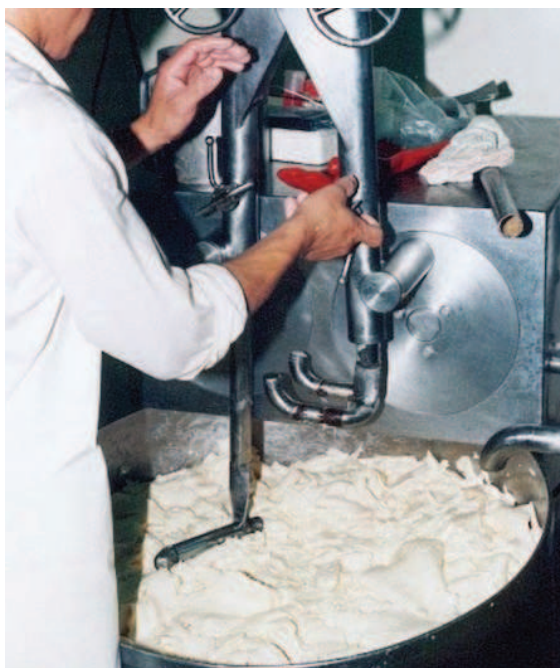
Figura 4.11 Vista del armado de una hiladora de brazos de inmersión
