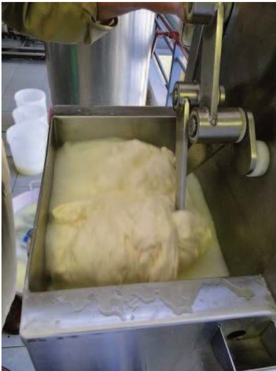
Figura 5.1 Hilado mecánico de la cuajada.
