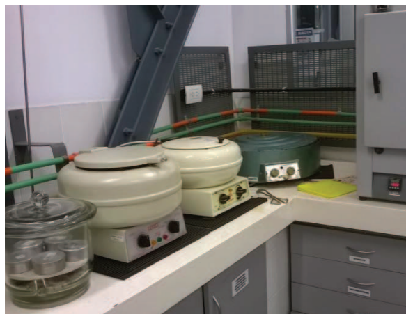
Figura 5.6 Análisis de humedad, secado en estufa a 102 °C.
