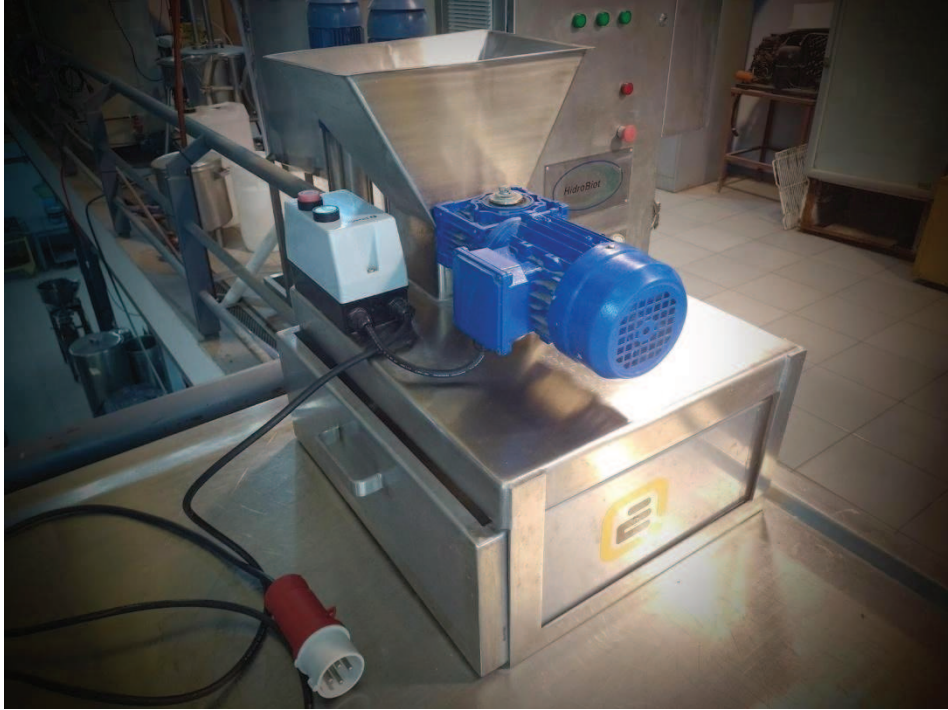
Figura 4.23 Cortadora de cuajada desarrollada para el INLAIN marca Equs.
