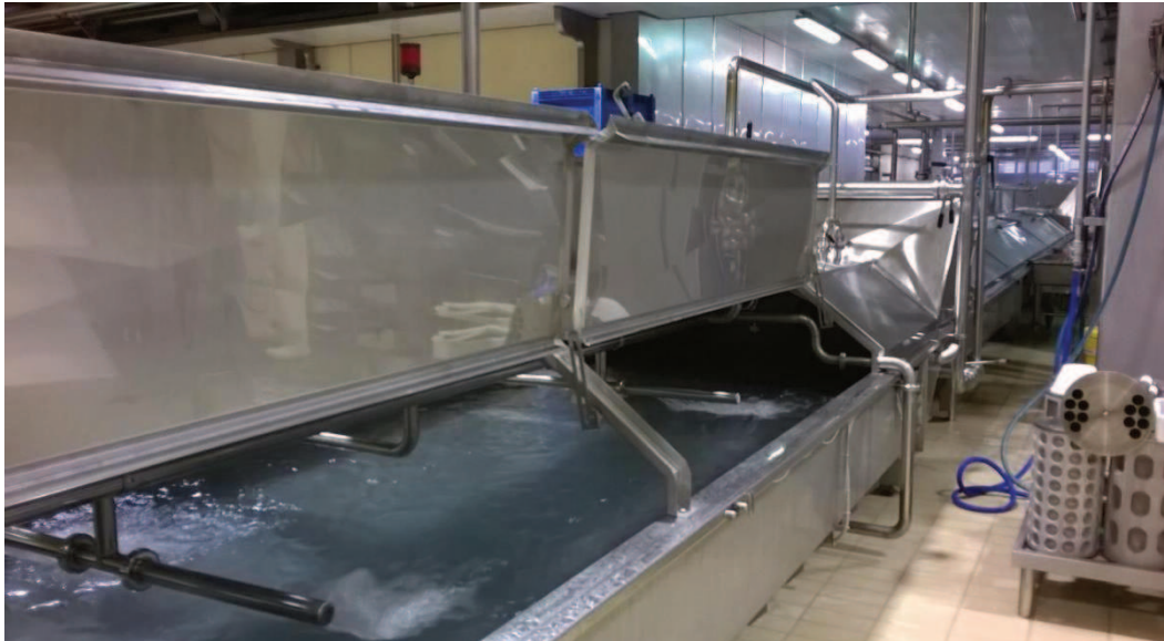
Figura 2.20 Canal de enfriamiento de la Mozzarella para pizza.
