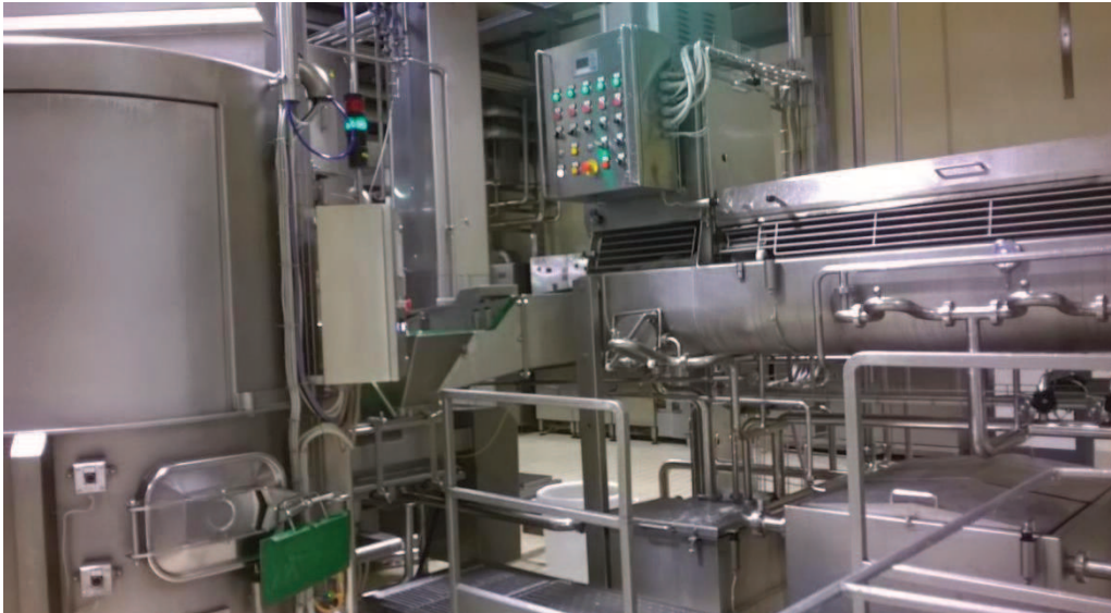
Figura 2.17 Hiladora de Mozzarella para pizza. Se observa sección de sinfín (derecha de la imagen), sección de brazos de inmersión (debajo del tablero de control), compartimiento para salado del agua de hilado (a la derecha abajo, con tapa de acero) y formadora tipo carrusel (izquierda).
