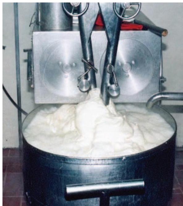
Figura 4.12 Etapa de hilado en una hiladora de brazos de inmersión
