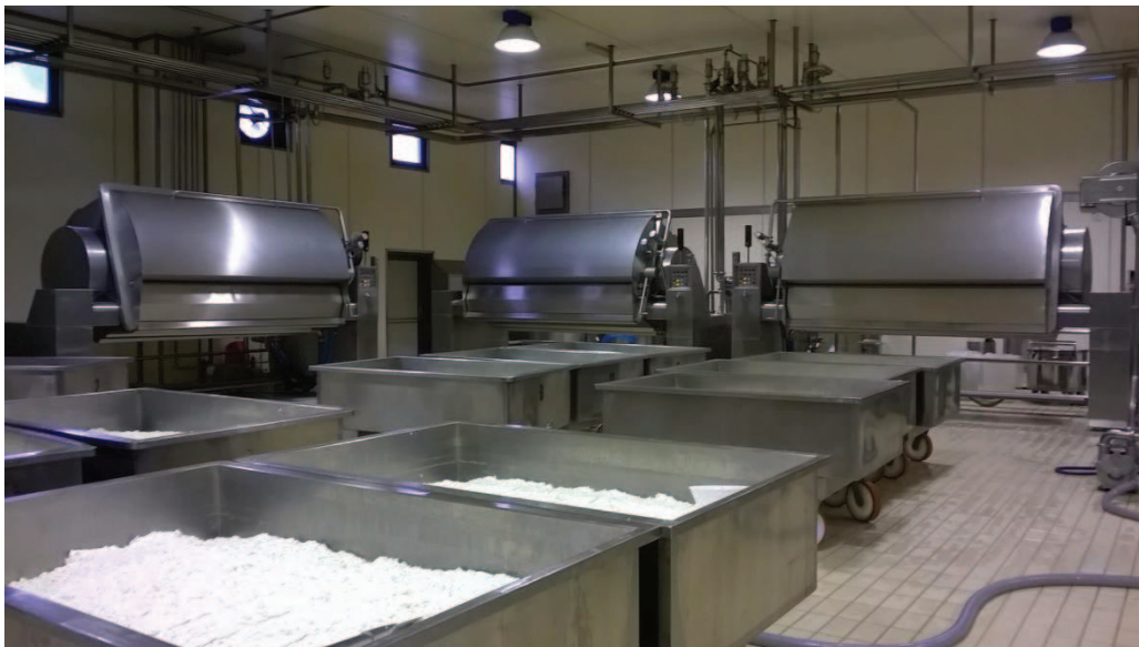
Figura 2.2 Vista de tres tinas polivalentes y bateas móviles de desuerado.
