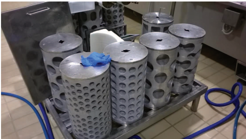
Figura 2.13 Cabezales con distintas formas para Mozzarella de alta humedad y Scamorza (primero a la derecha).
