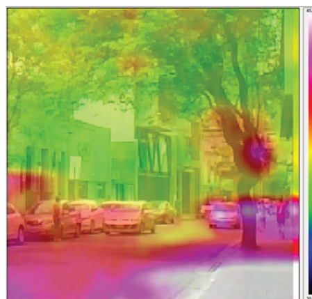
Figura 2: Análisis de temperaturas superficiales mediante cámara termográfica.
