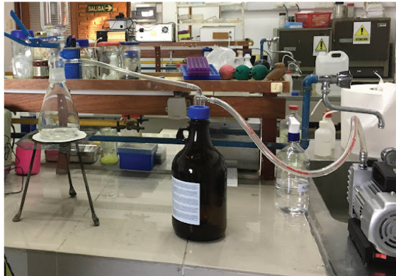
Figura 3: Filtrado de muestras de agua empleando bomba de vacío
