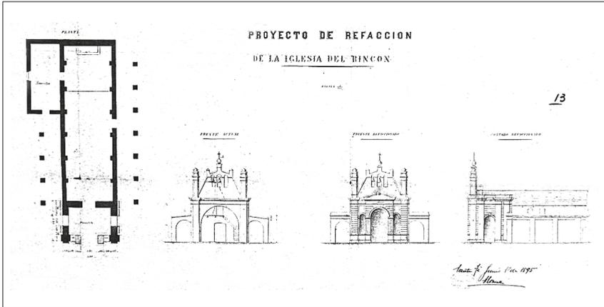
**Imagen 17.** Fotografía del plano original de A. Lomello (1895). Contiene relevamiento de la capilla de Castañeda y propuesta de reforma.
