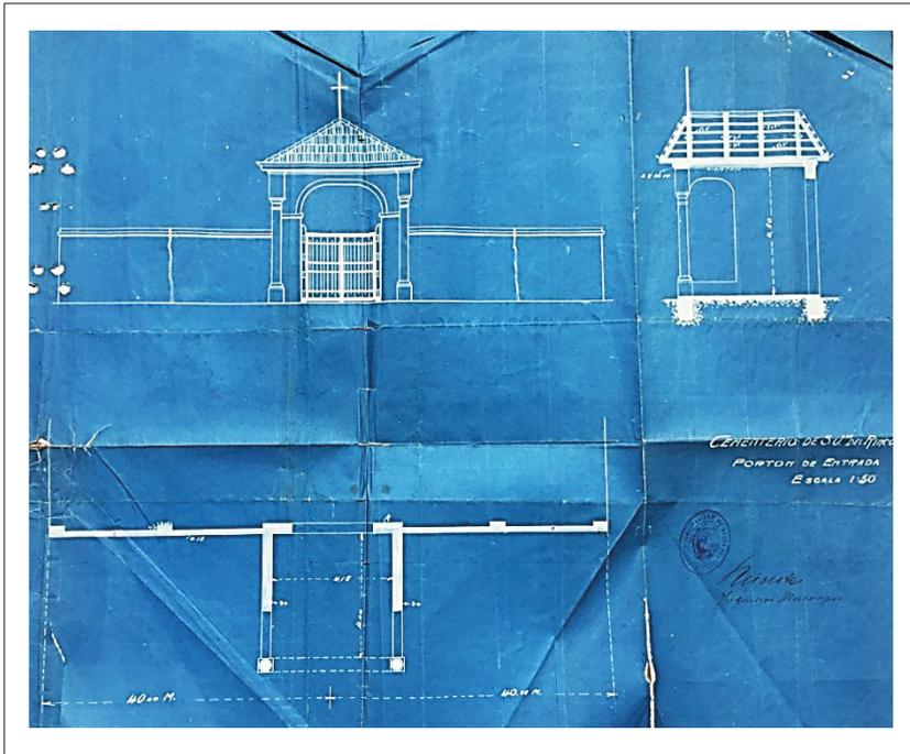
**Imagen 20.** Antiguo plano del «Portón de entrada» del cementerio de Rincón. Copia en ferroprusiato. Firma: Ingeniero Municipal. Sin fecha, con firma de autor no identificado
