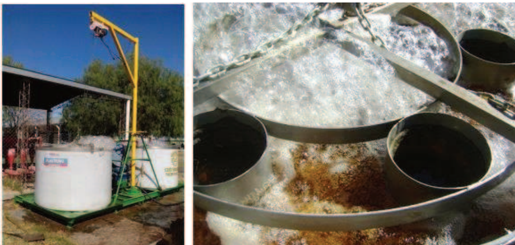
Figura 2.2. Biorreactor de compost para la obtención de abono líquido a partir del compost de alperujo. Frutos del Norte S.A., Pomán, Catamarca. 2014. Vista completa (izquierda); tolva, cilindros con AS sumergido en agua en agitación (derecha).
