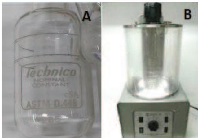
**Figura 4.** A: viscosímetro capilar. B: baño viscosimétrico con control de temperatura.
