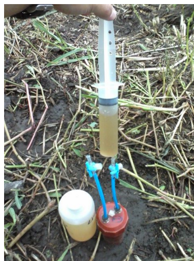
Figura 4.7.: Extracción de la solución del suelo con jeringa en el plot B después de 24 hs. de aplicación de succión al lisímetro.
