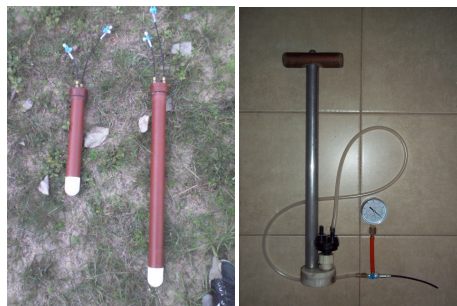
Figura 3.9.: Lisímetros de succión y bomba manual de succión para activar lisímetros.
