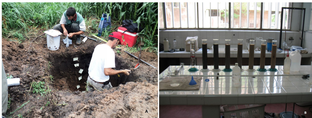
Figura 4.1.: A) Excavación y recolección de muestras de suelo para la determinación de las propiedades texturales de los horizontes. B) Determinación en laboratorio de las propiedades texturales de cada horizonte mediante el método de Bouyoucos (1927) .
