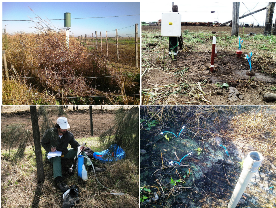
Figura 3.10.: Izquierda-arriba: Pluviógrafo a canchilones con registrador de datos ODYSSEY incorporado. Derecha-arriba: Lisímetros de succión y sensores de potencial matricial junto al registrador ODYSSEY en el interior de gabinete de protección en plot A. Izquierda-abajo: Piezómetro PZ1. Derecha-abajo: Lisímetros de succión en plot C junto al piezómetro para registro de niveles colgados en forma temporaria.
