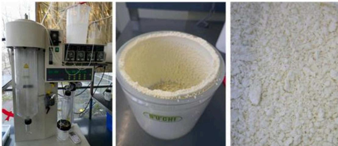
**Figura 11:** Secadero spray (Büchi) y polvo obtenido de *B. animalis* subsp. *lactis* INL1 para las condiciones temperatura de entrada 160°C y temperatura de salida 80°C.
