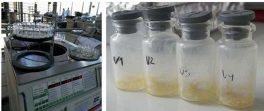
**Figura 12:** Liofilizador de mesada Gamma LSC 1-20 (Christ) y viales con cultivo de *B. animalis* subsp. *lactis* INL1 secado al vacío bajo las condiciones (b).
