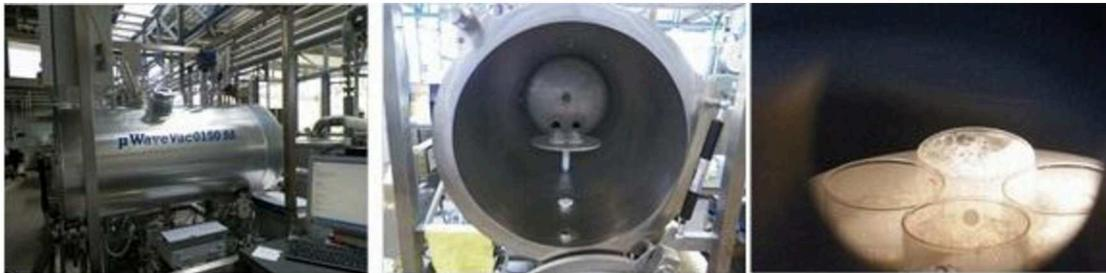
**Figura 13:** Equipo piloto para secado con microondas  $\mu$ WaveVac0150 (Püschner Microwave GmbH) y cultivo de *B. animalis* subsp. *lactis* INL1 secado al vacío con microondas a 2 W/g y presión de 7 mbar.
