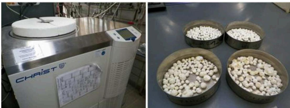
**Figura 10:** Liofilizador de mesada Alpha LSC 1-24 (Christ) y gránulos liofilizados de *B. animalis* subsp. *lactis* INL1 bajo las condiciones (b).
