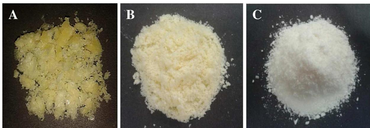
**Figura 4.28.** Apariencia visual de microcápsulas liofilizadas, preparadas con diferentes concentraciones (%p/p) de MDX: 0% (A), 10% (B) y 20% (C).
