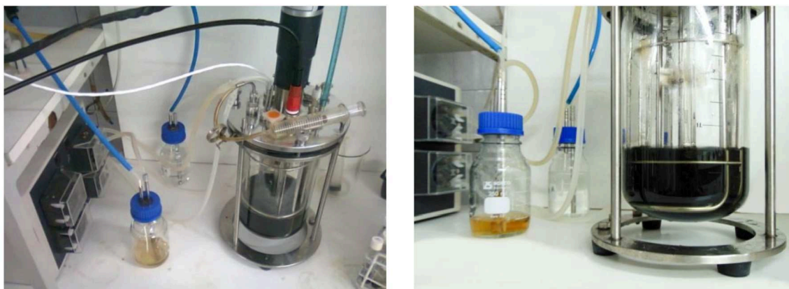
Figura 3.2: Reactor redox, recipiente con NaOH concentrada y reactor de síntesis.
