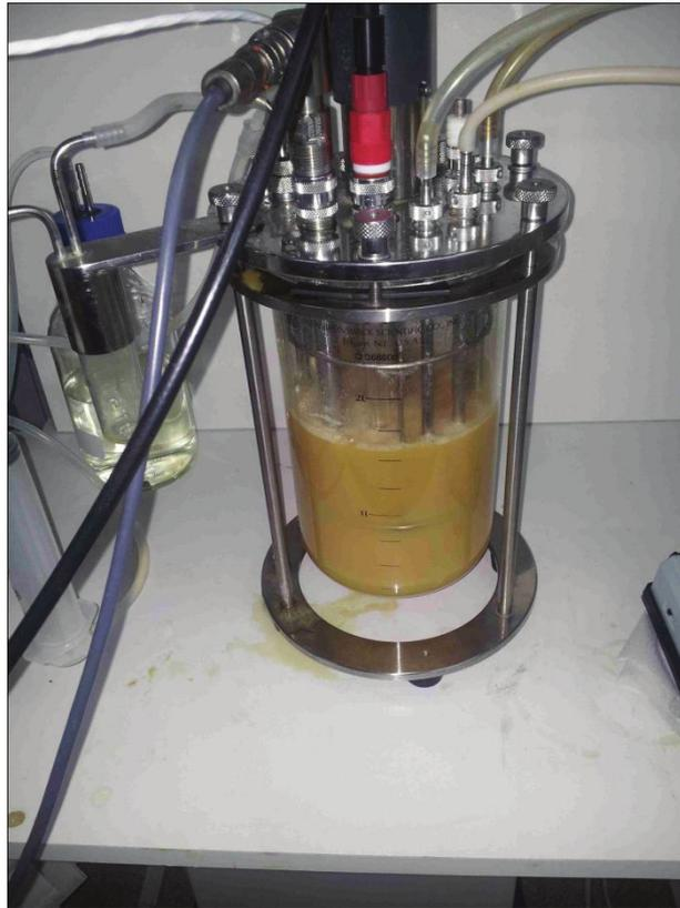
**Figura 5.5 - Biorreactor BioFlo 110 usado en los experimentos de este capítulo.**
